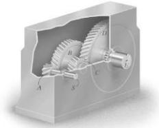
Fig. 6 Speed reducer [28].
